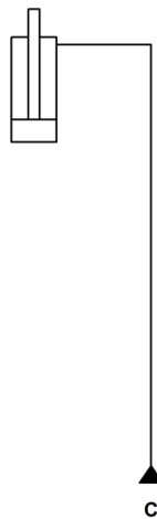
Hydraulisch schema tractor-aanspan 3 Enkele cilinder
